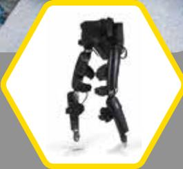
ReWalk ist ein am Körper getragenes Exoskelett. Es ermöglicht Menschen mit einer Querschnittslähmung durch motorisierte Hüften und Knie wieder aufrecht zu Stehen, zu Gehen, Kurven zu laufen und Treppen zu steigen. Über die Auswahl des gewünschten Betriebsmodus sowie die Unterarmgehstützen behält der Nutzer dabei die vollständige Bewegungskontrolle.
