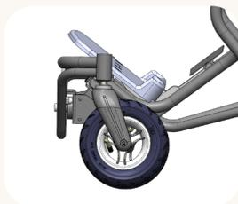
Durch das Schwenkrad Duo verkürzt sich der Vorderbau von JOSI-pro erheblich. Dieses kann bei engen Platzverhältnissen vonnöten sein. Das pendelnd gelagerte Schwenkrad Duo ist bestens für schlechte und unebene Gehwege geeignet.
