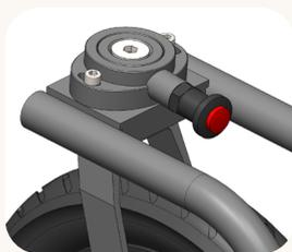
Das Vorderrad Pro vereint die Vorteile des Schwenkrads und des starren Vorderrads in Einem. Durch die Arretierung kann das schwenkbare 12" Rad am Drehpunkt festgestellt werden. Somit sind unebene Gehwege oder unbefestigte Wege kein Problem. Als weiterer Vorteil kann der Geradeauslauf stufenlos feinjustiert werden.
