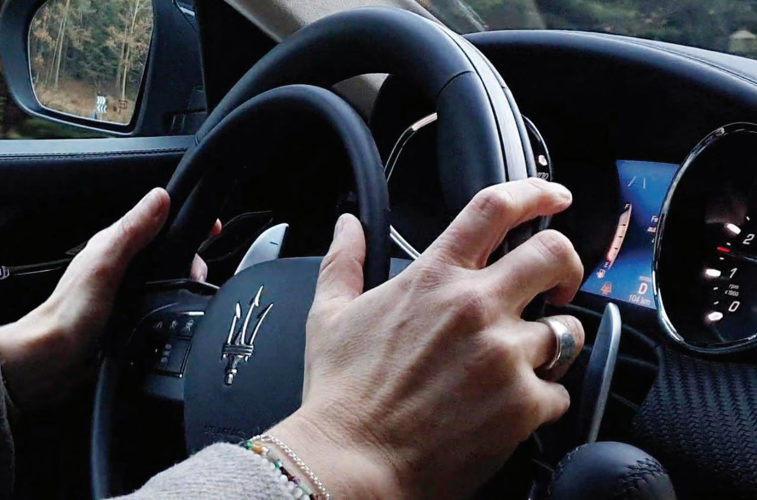
Ein Schalter am Armaturenbrett erlaubt das Umschalten zwischen dem Gasring und dem originalen Gaspedal.
