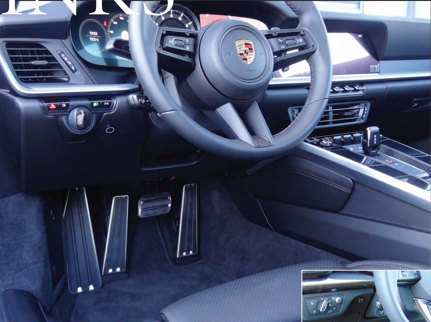
Ein Fahrer mit einer rechten Hemiplegie kann sein Fahrzeug mit einem Picado Drehkauf und einem Gaspedal links mit Sicherheit und Komfort fahren.
