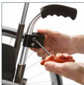
Anbringen der Montageblöcke
