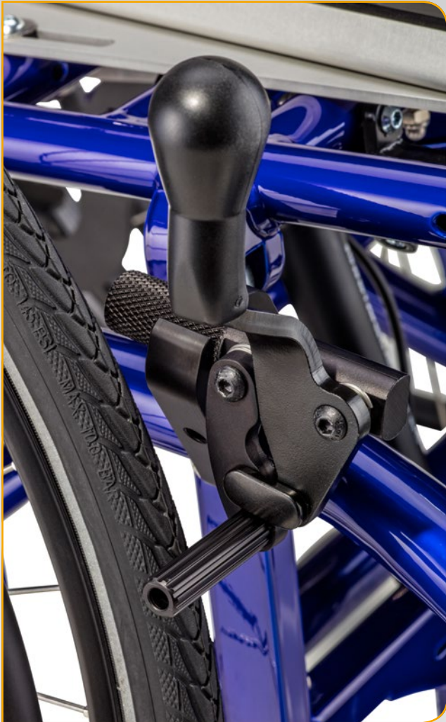
Kniehebelbremse knee lever brake
